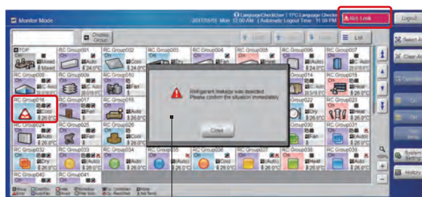
Wyskakujące okienko z informacją o wycieku
